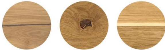
Pęknięcia krawędziowe i twarde
