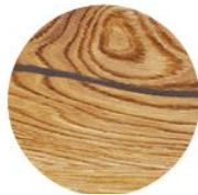
Pęknięcia krawędziowe i twardzieli
